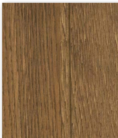
Drásaný, mořený a lakovaný povrch dubových dvířek
